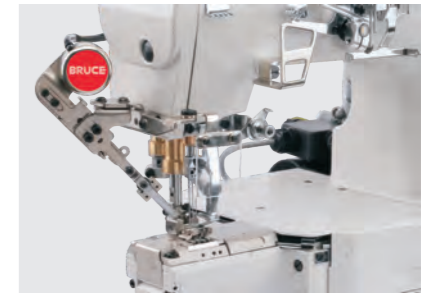
自动剪线，省人省线 Auto thread trimming
