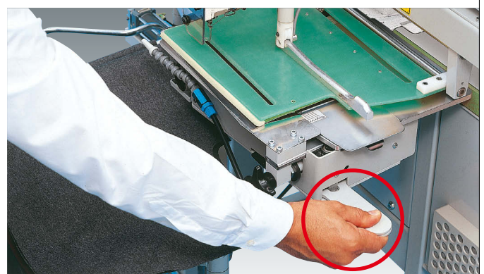
Abnäher-/ Bundfaltenwinkel von 0° bis 10° können durch die Schnellverstellung eingestellt werden.
