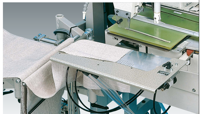
Vakuumtisch (0793 080000) für Nähgutaufnahme von links, empfohlen für schwierige und elastische Stoffe
