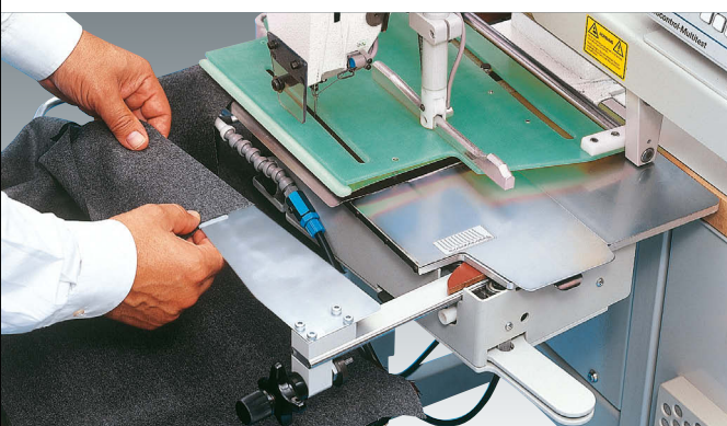
Das Nähgut wird auf dem Falttisch angelegt und ausgerichtet. Eine maximale Nählänge von 150 mm (abhängig vom Winkel und der Nahtform) ist realisierbar.
