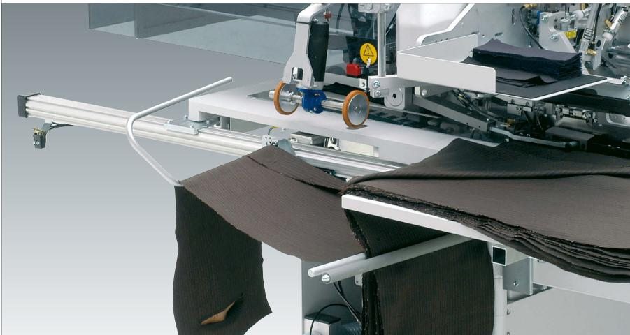
**Durch einen Ausstreifer** kann das Hosenbündel ordentlich weiterverarbeitet werden, ohne das zusätzlich das Bündel geordnet werden muss.
