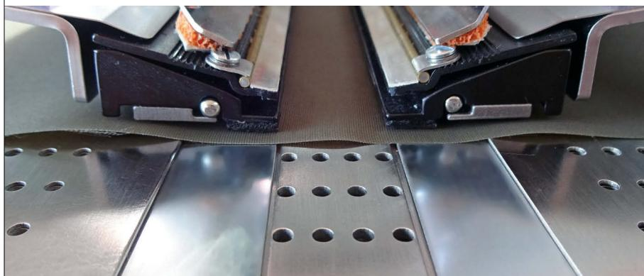
**Die optionalen Unterlegbleche** eignen sich hervorragend für die Verarbeitung mit Futter. Das Nähgut wird während des Transports von oben durch die Transportklammer und von unten von den Unterlegblechen gehalten.
