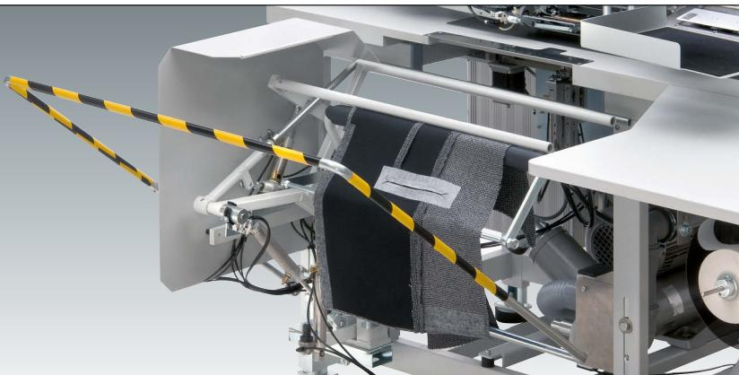
**Überwurfstapler** (0745 427554) zum sauberen Abstapeln von langen Teilen. Der Überwurfstapler senkt sich in der Arbeitshöhe mit wachsender Bündelgröße ab.
