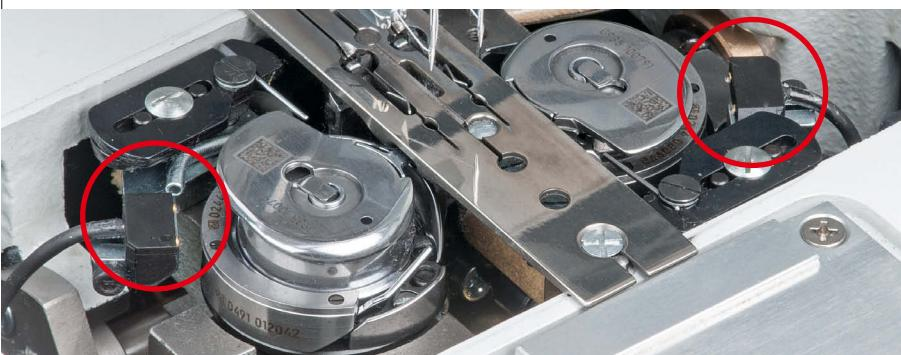
**Die Spulenrestfadenwächter** sind in der Grundausstattung der Nähanlage enthalten. Reduzierter Spulenwechsel durch großen Greifer.
