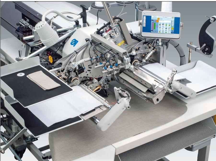
**Bei Sakkaußentaschen mit gleichzeitigen Annähen von Patte und zwei Taschenbeuteln** bietet die 745-35-10 B eine hervorragende Lösung. Der Teilesatz „Taschenbeutel über Patte“ (0745 598454) erreicht durch eine Durchsichtlichtschranke das Erkennen der Patte durch den darüber liegenden Taschenbeutel.
