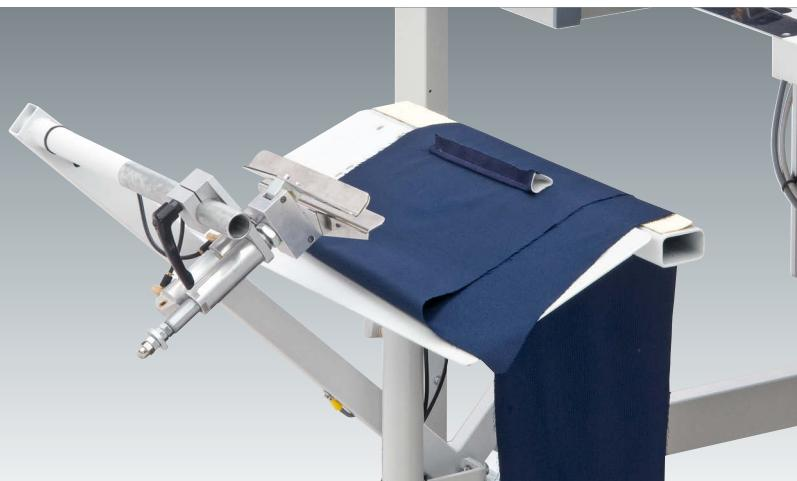
**Zangenstapler – universelle Abstapelvorrichtung – nur für 745-35-10 B** (0745 427544): Der Zangenstapler greift das Material und legt es auf dem verstellbaren Ablagetisch ab. Dieser Stapler eignet sich für kurze und lange Teile.
