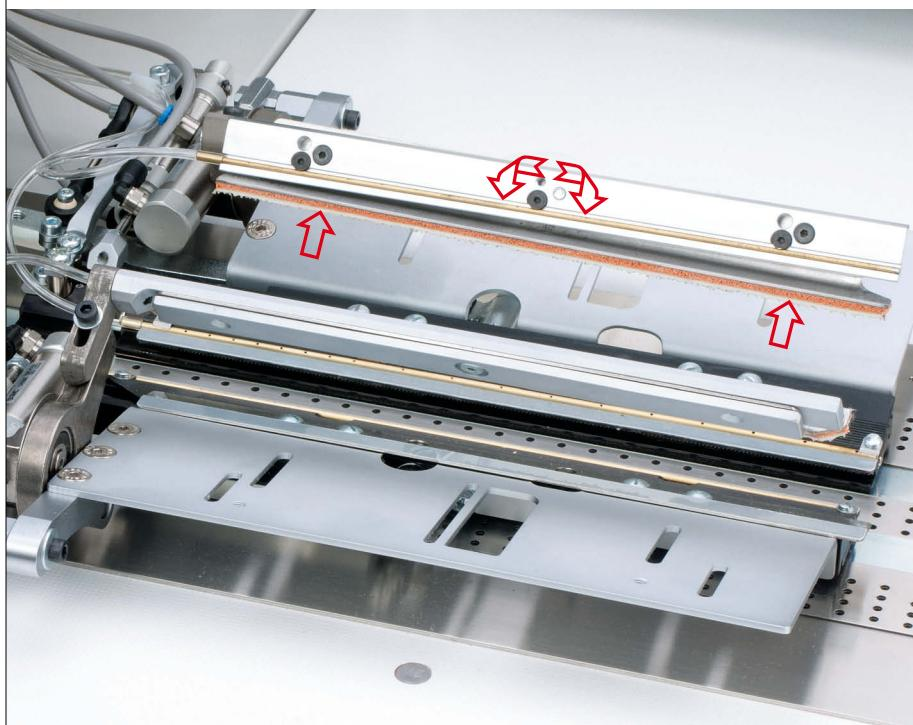
**Die Klammerleisten** sind sowohl flexibel als auch mit Vorspannung einstellbar. Dies unterstützt den Ausgleich von unterschiedlichen Materialstärken.
