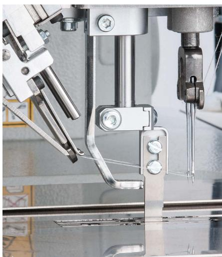
**Schrittmotor gesteuerter Mittelmesserantrieb** mit erweiterter Flexibilität im Materialeinsatz durch erhöhten Materialdurchgang und verstellbarer Hubbühne zur Anpassung an die Materialdicke – reduzierter Messerverschleiß
