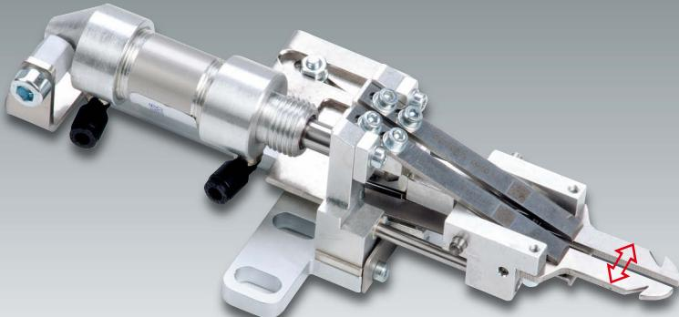
**Die Schneideeinrichtung** für Nadelfäden ist schnell und stufenlos verstellbar. Oberfadenfänger für Nadelabstände von 6 bis 22 mm sind standardmäßig enthalten. Für Nadelabstände von 22 bis 30 mm ist ein weiterer Oberfadenfänger optional erhältlich (0755 350554).
