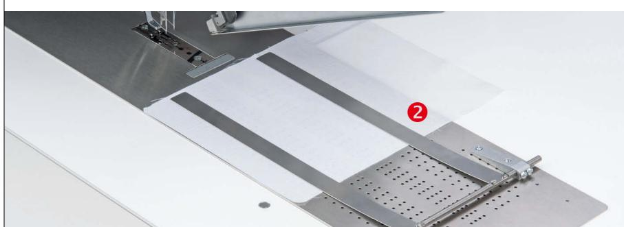
**Teilesatz „Taschenbeutelklemme“** (0755 590714) für die Anwendung mit schmalen Taschenbeuteln (z. B. Hosen-taschen-Verarbeitung ①) und/oder für Anwendungen, bei denen der Taschenbeutel am vorderen Anlegepunkt positioniert werden soll (z. B. Sakkotaschen-Verarbeitung ②).
