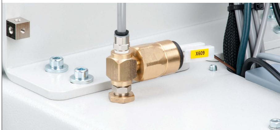
**Der Druckwächter** überwacht die pneumatischen Funktionen, um bei Druckabfall die Maschine zu deaktivieren. Eine USV (option) garantiert ununterbrochene Stromversorgung bei Stromausfall oder Netzschwankungen.
