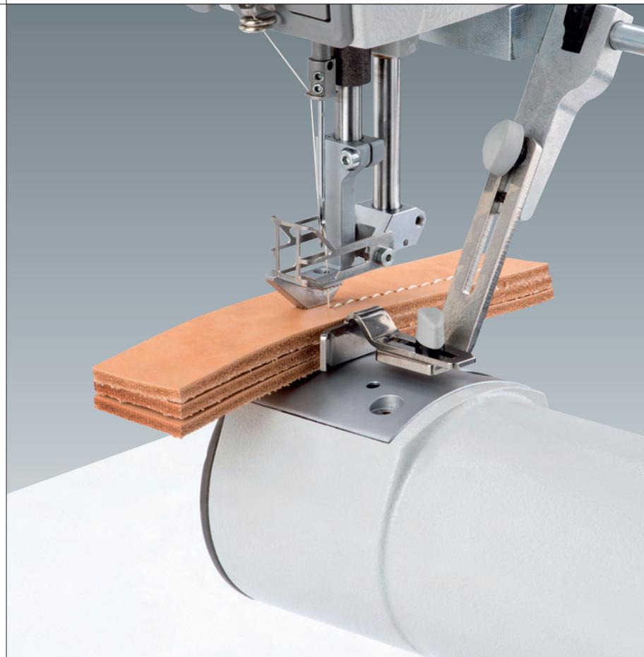
Die besonders robuste Bauweise und der durchzugskräftige Dreifachtransport sorgen für höchste Qualität speziell bei der Verarbeitung extremer Material- und Nähgarnstärken.
