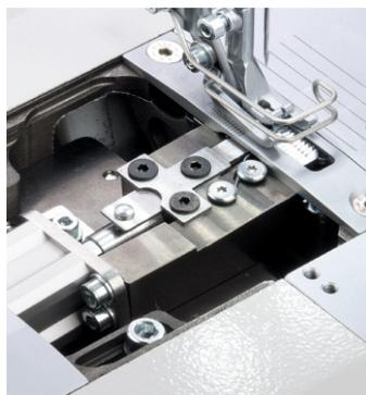
**Zusatzfunktion „Sauberer Nahtanfang“ (NSB)** – Die optionale Zusatzfunktion „Sauberer Nahtanfang“ (NSB, Teile-Nr. 0867 594324) garantiert einen optisch perfekten Nahtanfang mit minimierter Fadenmenge unter dem Nähgut.
