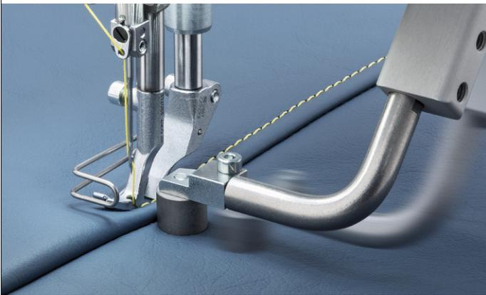
**Programmierbare Kantenansläge** – Motorisch angetriebene Kantenansläge sind die ideale Ergänzung für jede M-TYPE DELTA-Maschine. Einachsige (Teile-Nr. 4867 590014, Option) und zweiachsige (Teile-Nr. 4867 590024, Option) Kantenansläge ermöglichen das automatische Anfahren individuell programmierbarer Abstände und Höhen in jedem Nahtsegment, reduzieren so Rüstzeiten und erhöhen die Prozesssicherheit.
