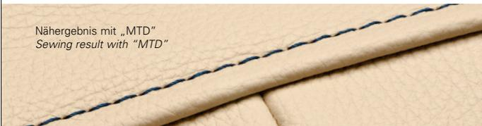
**Automatische Materialstärkenerkennung (MTD)** – Alle Unterklassen der D867 verfügen serienmäßig über eine Einrichtung zur Messung der unter den Nähfüßen vorhandenen Materialstärke. Mit diesem Messwert kann während des Nähprozesses auf wesentliche Nähparameter wie Fadenspannung, Stichlänge, Nähfußhub, Nähfußdruck und Nähgeschwindigkeit aktiv Einfluss genommen werden, um das Nähergebnis den Anforderungen optimal anzupassen. Die Resultate sind beeindruckend:
