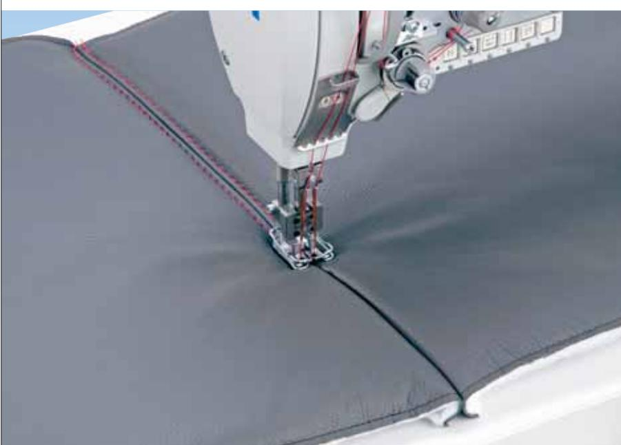
Nächeinrichtungen mit Ausgleichfuß und integrierter Nahtmittlenführung garantieren ein perfektes Nähergebnis bei qualitativ hochwertigen Ziernahtapplikationen.
