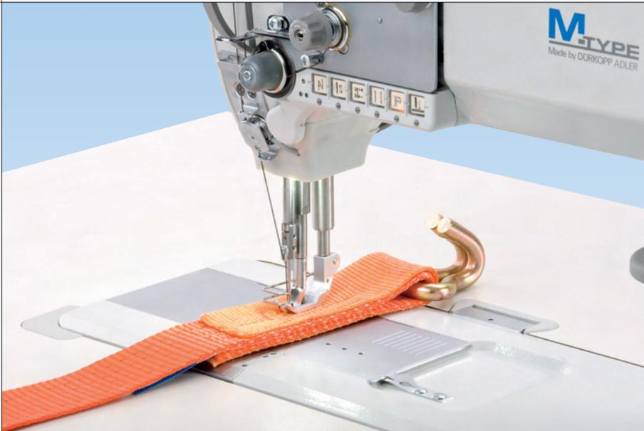
**M-TYPE H867-190362 CLASSIC –** Sicherheits- und Funktionsnähte im Bereich Technische Textilien erfordern oftmals ein durchzugskräftiges Transportsystem und einen Nadelantrieb mit hoher Durchstichkraft.
