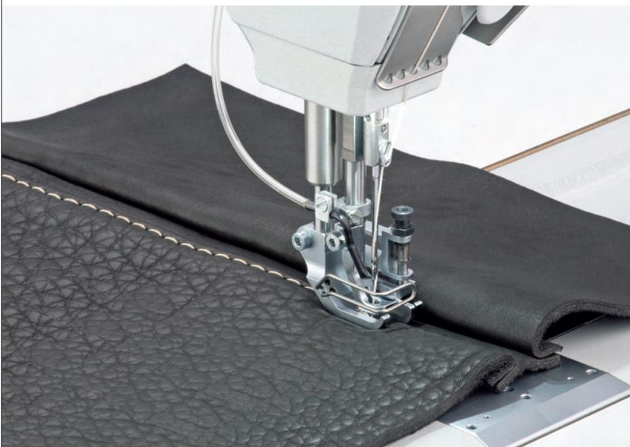
**M-TYPE H867-190362 CLASSIC –** Die spezielle Näheinrichtung mit integriertem Kantenanschlag im Drückfuß zum Nähen von dekorativen Einfachkappnähten im Bereich der Wohnpolsterfertigung ermöglicht die problemlose Verarbeitung von extremen Nähgutstärken.
