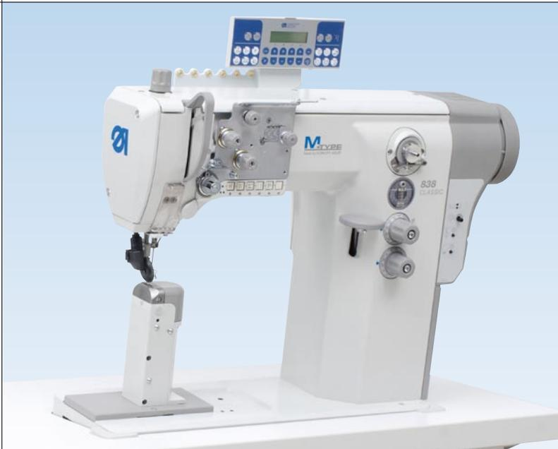
**838-170522-M:** Einnadel-Doppelstepstich Säulenmaschine (rechtstündige Säule) mit angetriebenem Rollfuß und Untertransport, mit elektromagnetischem Fadenabschneider, integrierter zweiter Stichlänge, elektropneumatischer Nahtverriegelung und Nähfußlüftung, mit großem zweiteiligen Vertikalgreifer, Sicherheitskupplung, einer Nähfußhöhe von 12 mm, einer Stichlänge von bis zu 8 mm und einer max. Nähgeschwindigkeit von 2000 Stichen/Min.
