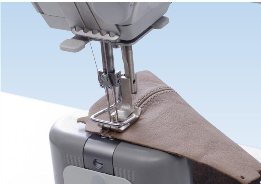
**838-270522-M:** Der Umbau als Nadeltransport mit Presserfuß anstelle des angetriebenen Rollfußes ermöglicht die Verarbeitung von Textilien und Leder auch ausserhalb der Schuhindustrie.
