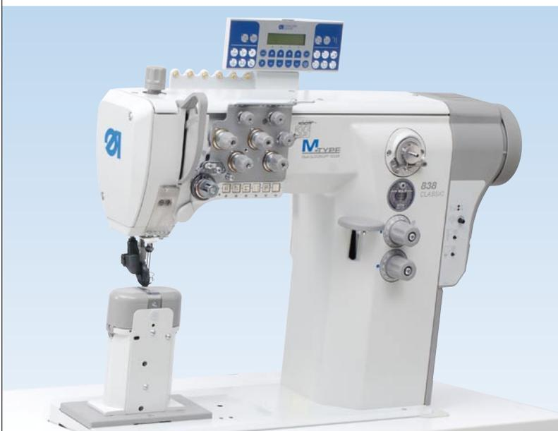
**838-270522-M:** Zweinadel-Doppelstepstich Säulenmaschine mit angetriebenem Rollfuß und Untertransport, mit elektromagnetischem Fadenabschneider, integrierter zweiter Stichlänge, elektropneumatischer Nahtverriegelung und Nähfußlüftung, mit großen zweiteiligen Vertikalgreifern, Sicherheitskupplung, einer Nähfußhöhe von 12 mm, einer Stichlänge von bis zu 8 mm und einer max. Nähgeschwindigkeit von 2000 Stichen/Min.
