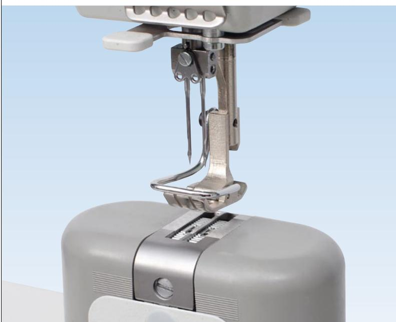
**828-270522-M:** Ein Umbau in Zweinadel Nadeltransport mit Presserfuß ist optional möglich.
